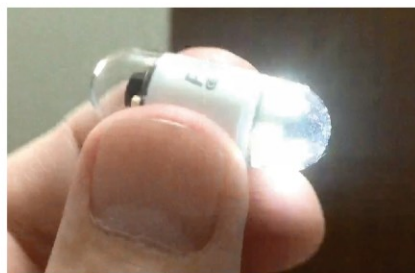
図2 大腸カプセル内視鏡 LEDの技術が使用されている
